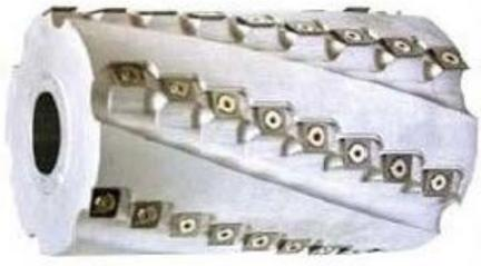
**Рисунок 3. Фреза с твердосплавными режущими элементами**
