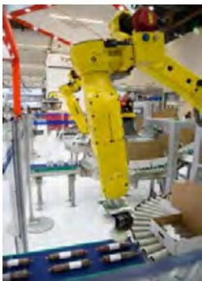
Рисунок 5. Робот для укладки колбас в коробки
