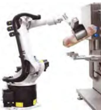
Рисунок 6. Робот для навешивания колбас на раму
