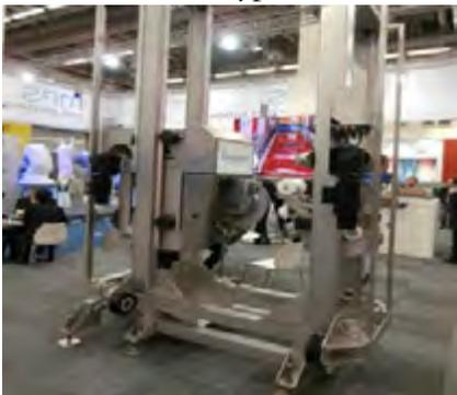
Рисунок 1. Автоматизированная установка фирмы Durand (MPSgroup) для распиловки туш свиней
