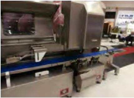
Рисунок 10. Установка Falconhybrid для нарезки мяса на порции фирмы Treif
