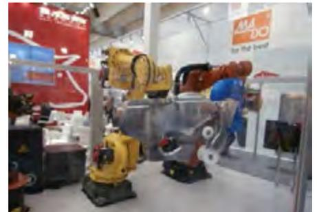
Рисунок 3. Роботы для разделки туш
