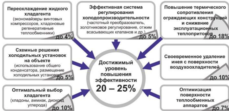
Рисунок 2 – Потенциальный уровень повышения эффективности производственных и распределительных холодильников
