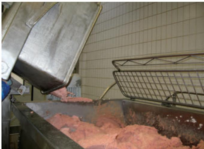
**Рис. 4. Перемешивание измельченного сырья со специями в мешалке «VVS»**
