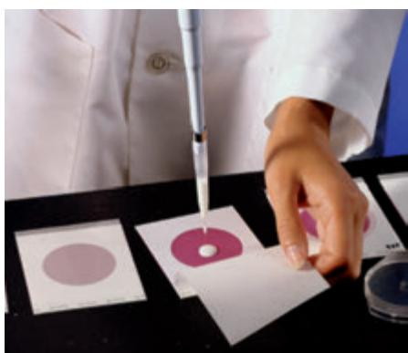
При прямом исследовании поверхности объектов (оборудование, инвентарь, руки, одежда персонала) пластины прикладывают к испытуемой поверхности.
