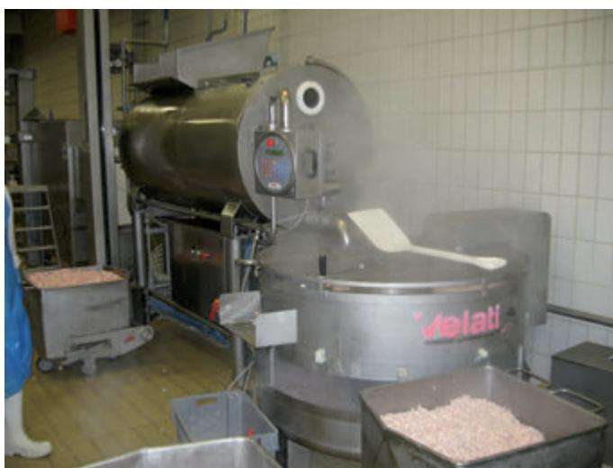
**Рис. 5. Промывка шпика и удаление от него горячей воды**
