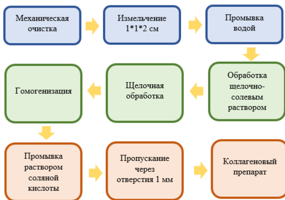
Рис. 4. Схема получения коллагенового препарата
