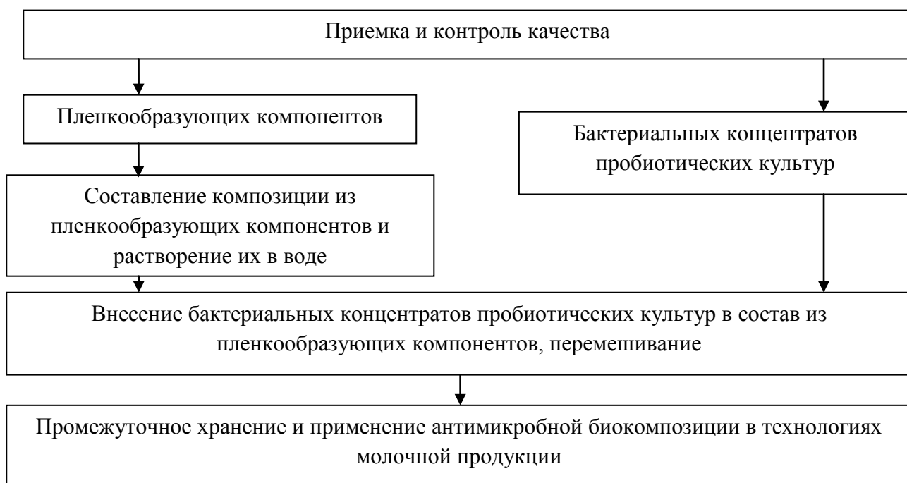
Рисунок 5 – Принципиальная схема получения антимикробной биокомпозиции
