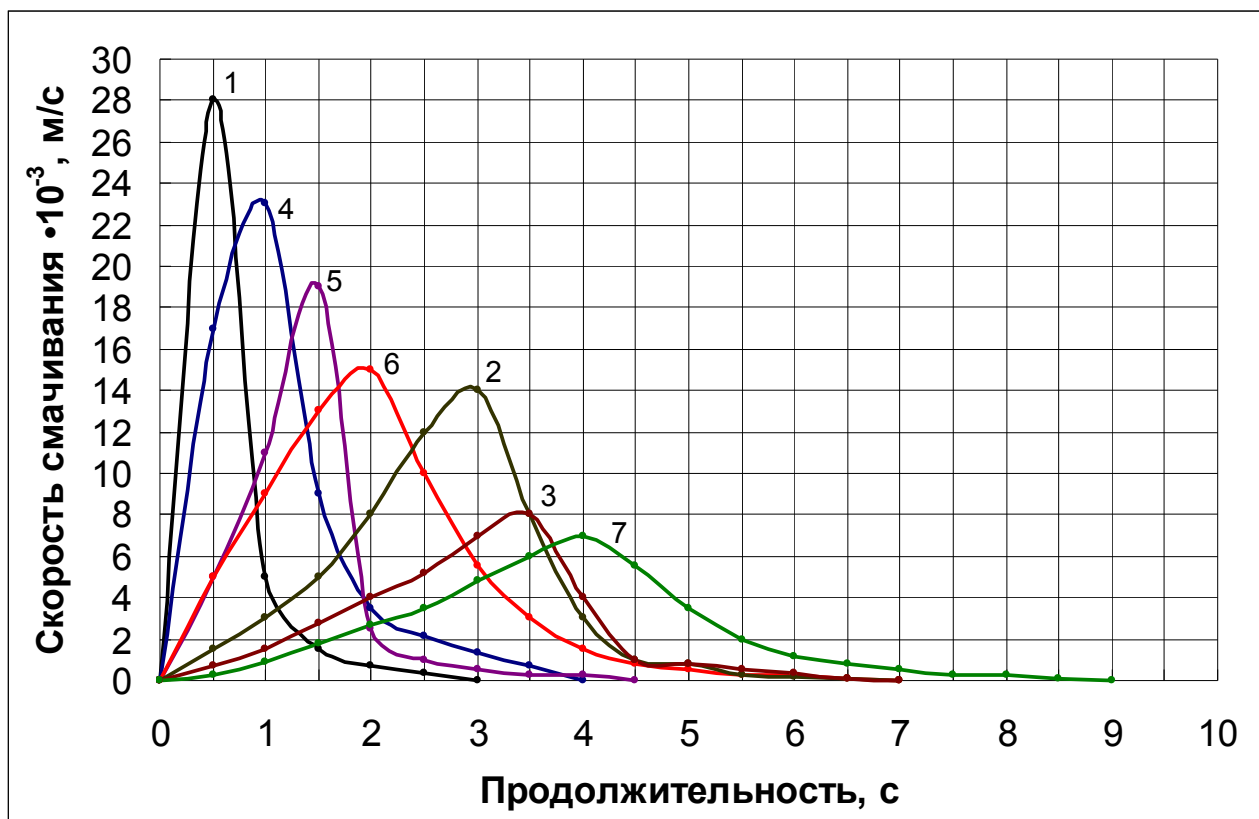
Рис. 2. Динамика скорости смачивания эмульгаторов по поверхности жира ( t=62\pm 3^{\circ}\text{C} )
