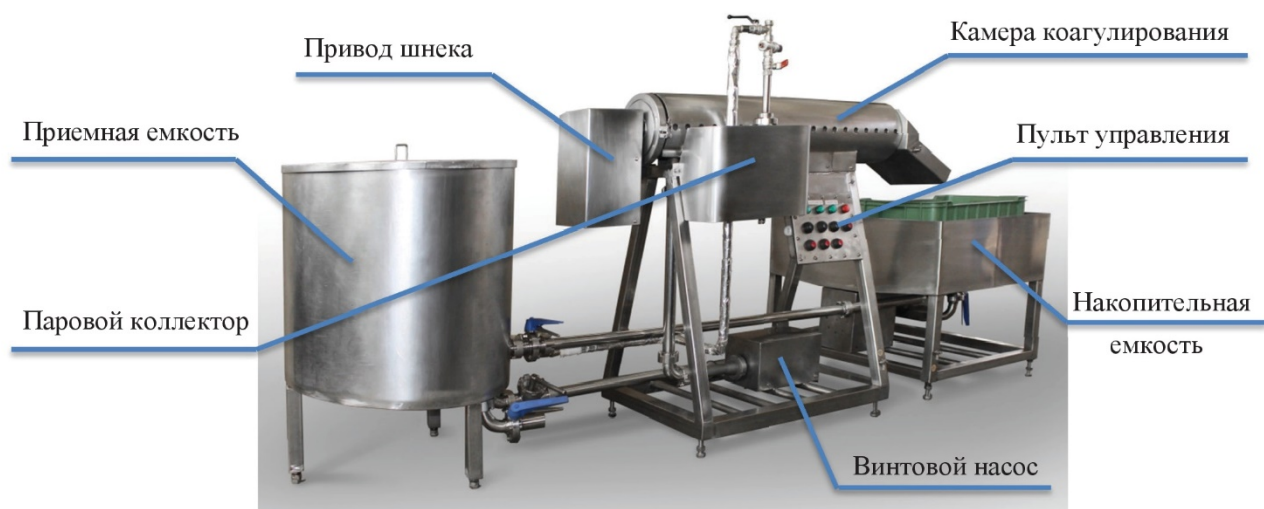
Рисунок 1. Внешний вид установки на базе пароконтактного коагулятора
