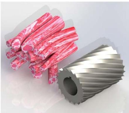
**Рисунок 10. Анизотропия замороженного мясного блока**
