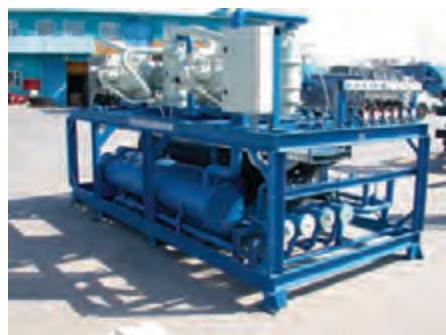
**Рисунок 3. Холодильная установка производительностью 1,2 мВт для получения ледяной воды непосредственным охлаждением в испарителе**
