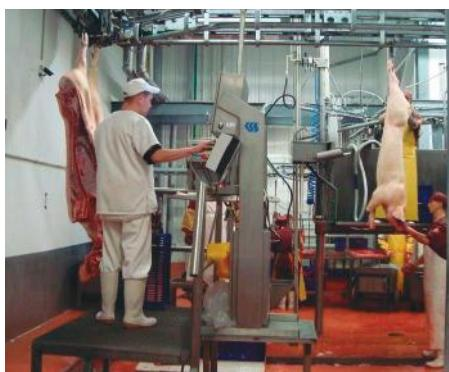
сырья, а также ветеринарном контроле туш информации по осмотру на прямую регистрируется в системе CSB на соответствующей рабочей станции CSB-Rack, а информация надежно присваивается каждой конкретной тушке.
