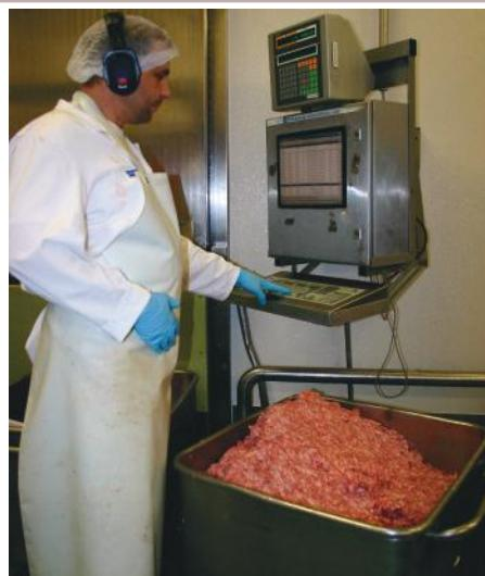
нитора высвечивается рецептура с указанием наименований необходимых компонентов и их количеств. При взвешивании каждого из них система контролирует отклонения от заданных предельных значений веса с выводом на монитор соответствующей информации. На монитор могут автоматически выводиться контрольные указания для сотрудника из модуля управления качеством (измерение температуры, жирности, отбора проб для лаборатории).
