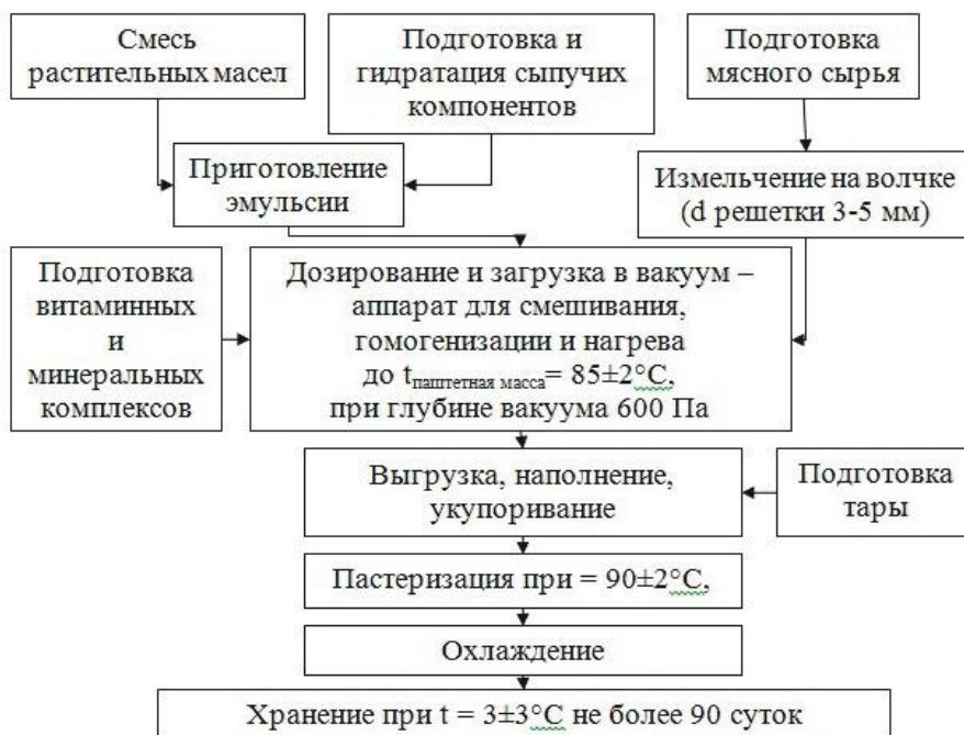
Рисунок 1. Технологическая схема производства специализированных продуктов на мясной основе для питания юных спортсменов
